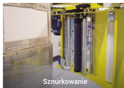
Aplikator folii przykryciowej dla trybu pyłoszczelnego i bryzgoszczelnego
